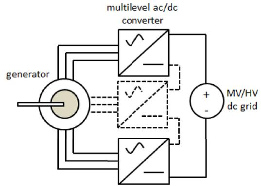
Fig. 16. Generator–converter modular multilevel system.
