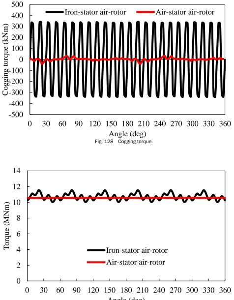
Angle (deg) Fig. 129 Rated torque.
